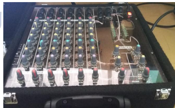
Gambar 4 Trainer audio mixer tampak dari depan
