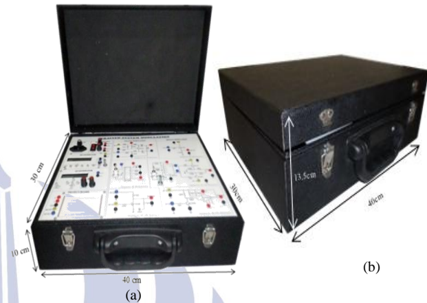
Gambar 13. (a) Trainer bagian dalam, (b) Trainer bagian luar (Sumber: Dokumen Pribadi)
